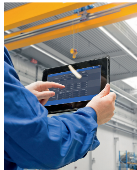
Gerade für Kranführer, die nur gelegentlich Lasten mit einem Laufkran bewegen, bietet ABU Control zusätzliche Sicherheit. Durch die Pendeldämpfung wird beispielsweise Lastpendeln verhindert.
