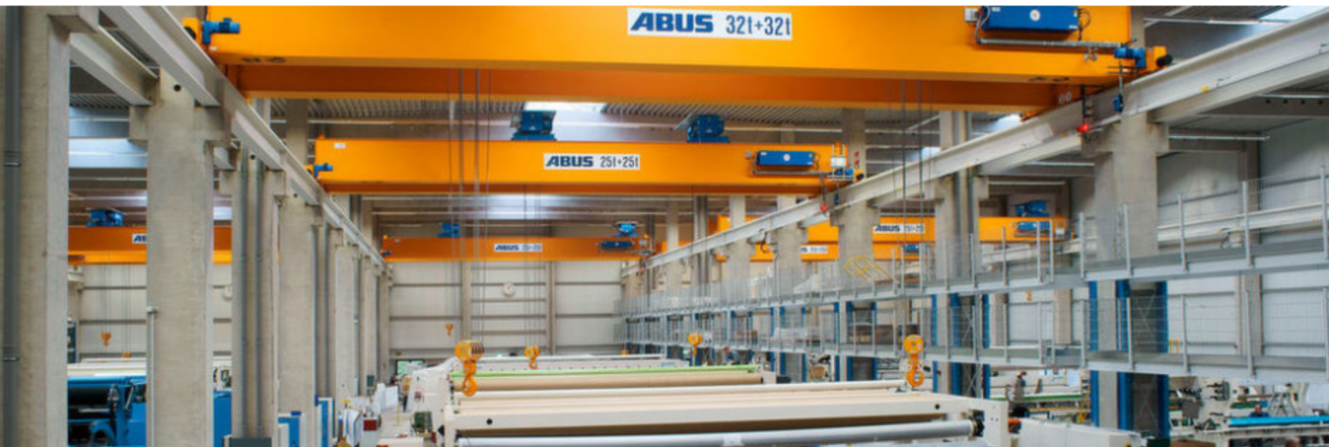
Bei weit auseinanderliegenden Anschlagpunkten kann durch den Einsatz von zwei Katzen der Einsatz einer Lasttraverse verhindert werden. ABUControl sorgt dabei für Gleichlauf von Fahrtrieben und Hubwerken. (Bild: ABUS)
